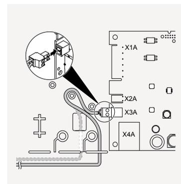
Connectez les autres extrémités des 2 fils aux bornes P1/P2 de l'unité intérieure.
