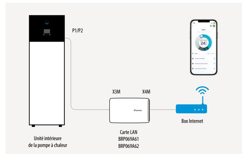
**Attention :** le câble Ethernet fourni en tant qu'accessoire mesure 1 m de long. Il est cependant possible d'utiliser un câble Ethernet non fourni. Dans ce cas, respectez la distance maximale autorisée entre l'adaptateur LAN et le routeur, qui correspond à 50 m pour des câbles Cat5e, et 100 m pour des câbles Cat6.
